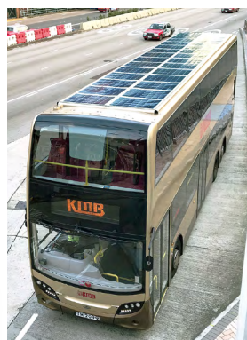
28塊第二代太陽能板安裝在巴士車頂一個鋁架上。
