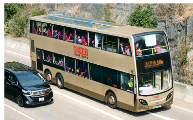
九巴第一代設計的太陽能板巴士，車頂安裝了20塊太陽能板。
